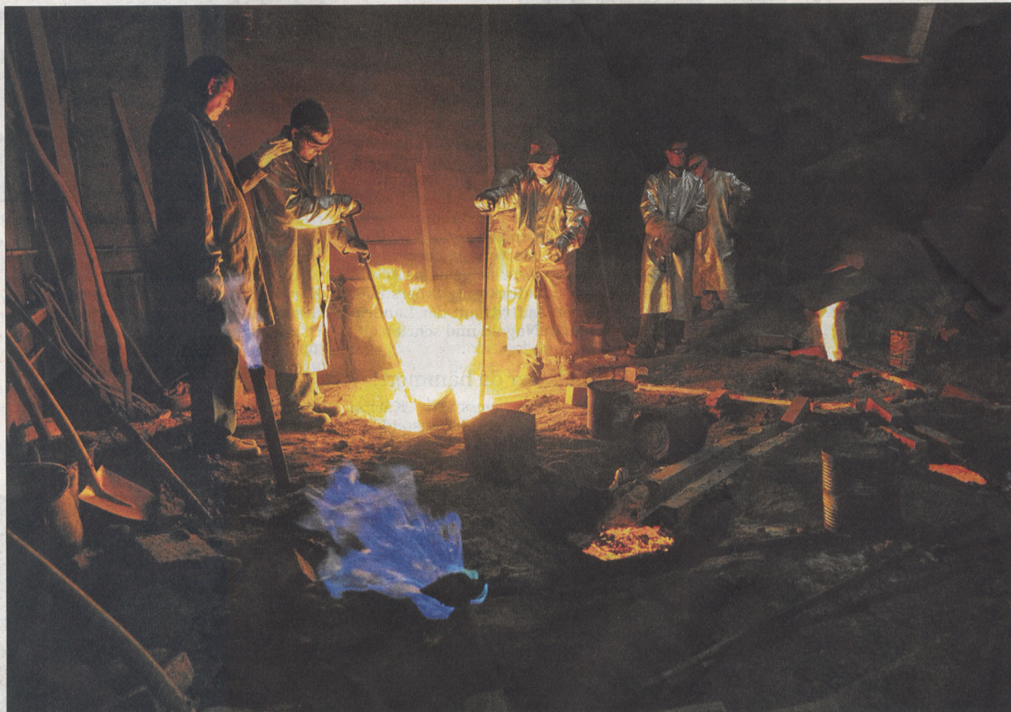
DUNKEL UND HEISS ist es in der Halle der Glockengießerei Bachert: Vorsichtig füllen die Mitarbeiter die 1 020 Grad heiße Bronze-flüssigkeit in die Glockenformen, die in einem Sandbett verborgen sind. Foto: Alàbiso
